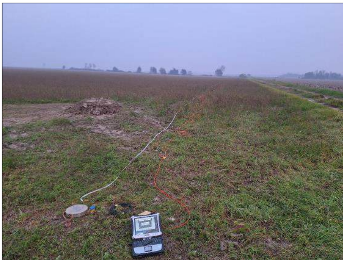
Figura 4.2: esecuzione dell'indagine sismica MASW
