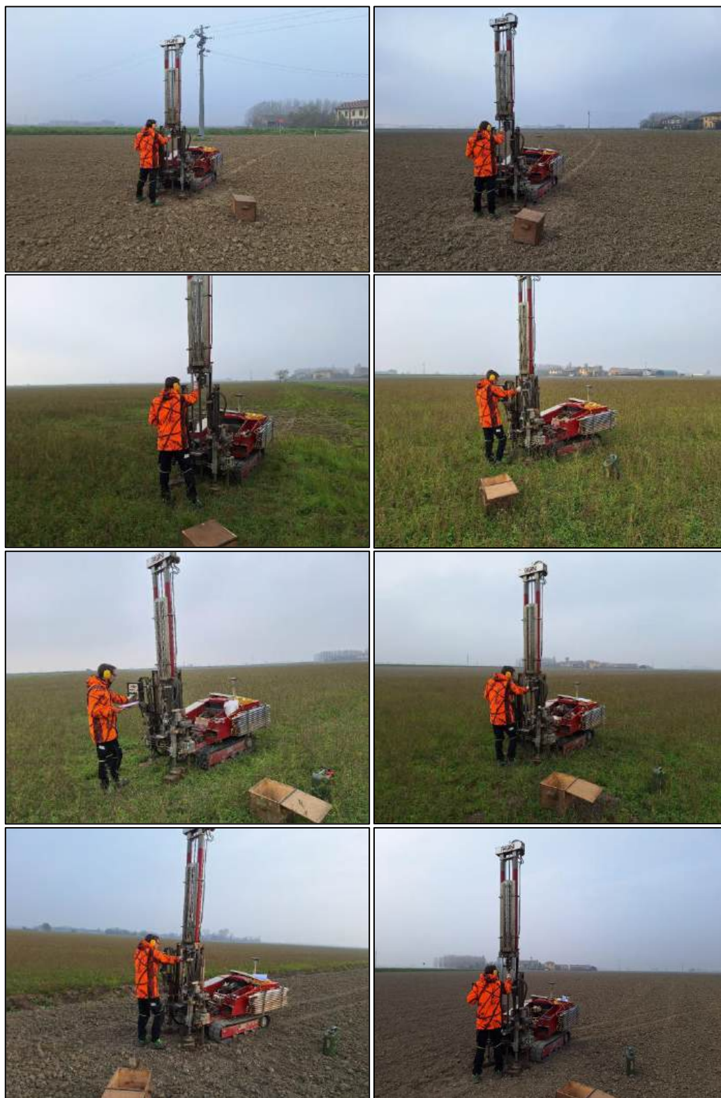
Figura 5.1: esecuzione delle prove penetrometriche statiche
